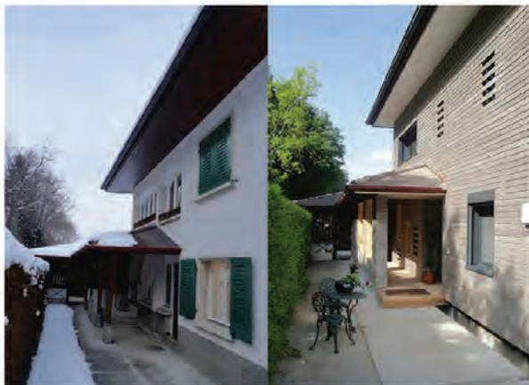
La rénovation des façades de la maison avec une structure en assature bois isolée et de nouvelles fenêtres triple vitrage a permis de réduire les besoins énergétiques de près de 90% alors que la surface habitable a augmenté.
